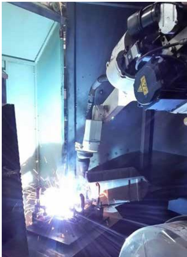
Mechanizované svařování metodou MAG s plynem Ferroline C18
