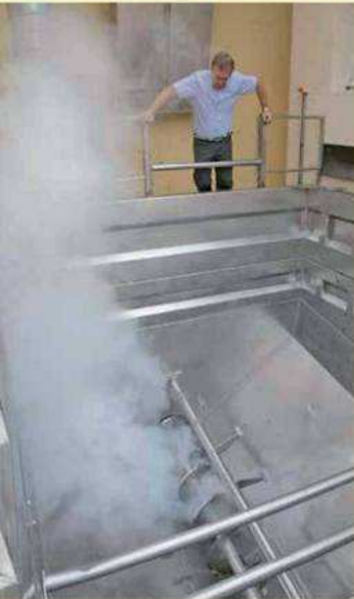
Jean-Yves Berlie kontroluje nádobu, ve které jsou uloženy hrozny po sklizni. Hrozny se chladí a inertizují předtím, než se přepravují k lisu.
