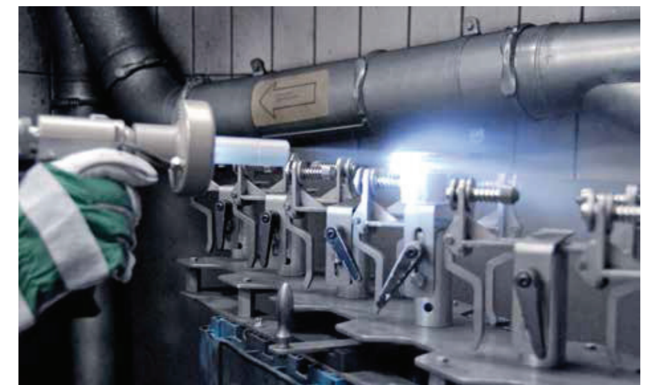
Svetelný veniec namontovaný na pištoľi osvetľuje úzku drážku piestového krúžku počas čistenia.
