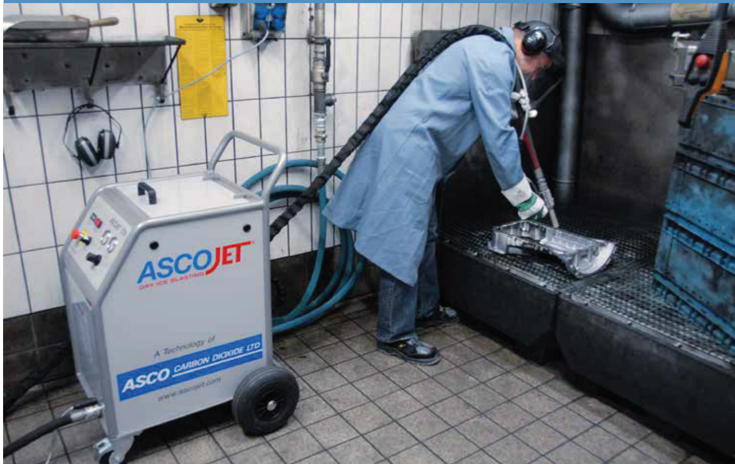
Čistenie stavebnej zložky motora technológiou tryskania suchým ľadom od ASCO Kohlensäure
