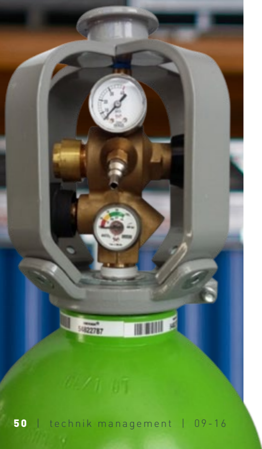
▼ Integrovaný lahvový a redukční ventil.
